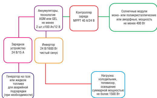
Рис.6. Автономная система электропитания мощностью 1600 ВА
