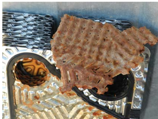
Рис. 2. Отложения на теплообменной поверхности пластинчатого теплообменного аппарата
