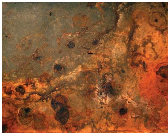
Рис. 1, 2. Внешний вид кислородной коррозии
