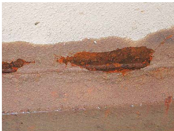
Рис. 5. Язвенная коррозия стали
