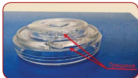
Рис. 1. Трещина пластиковой детали в редукторе регулятора в условиях эксплуатации при температуре -40^{\circ}\text{C}
