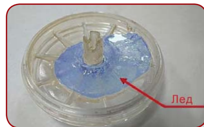
Рис. 3. Большой кусок льда в ПЗК регулятора
